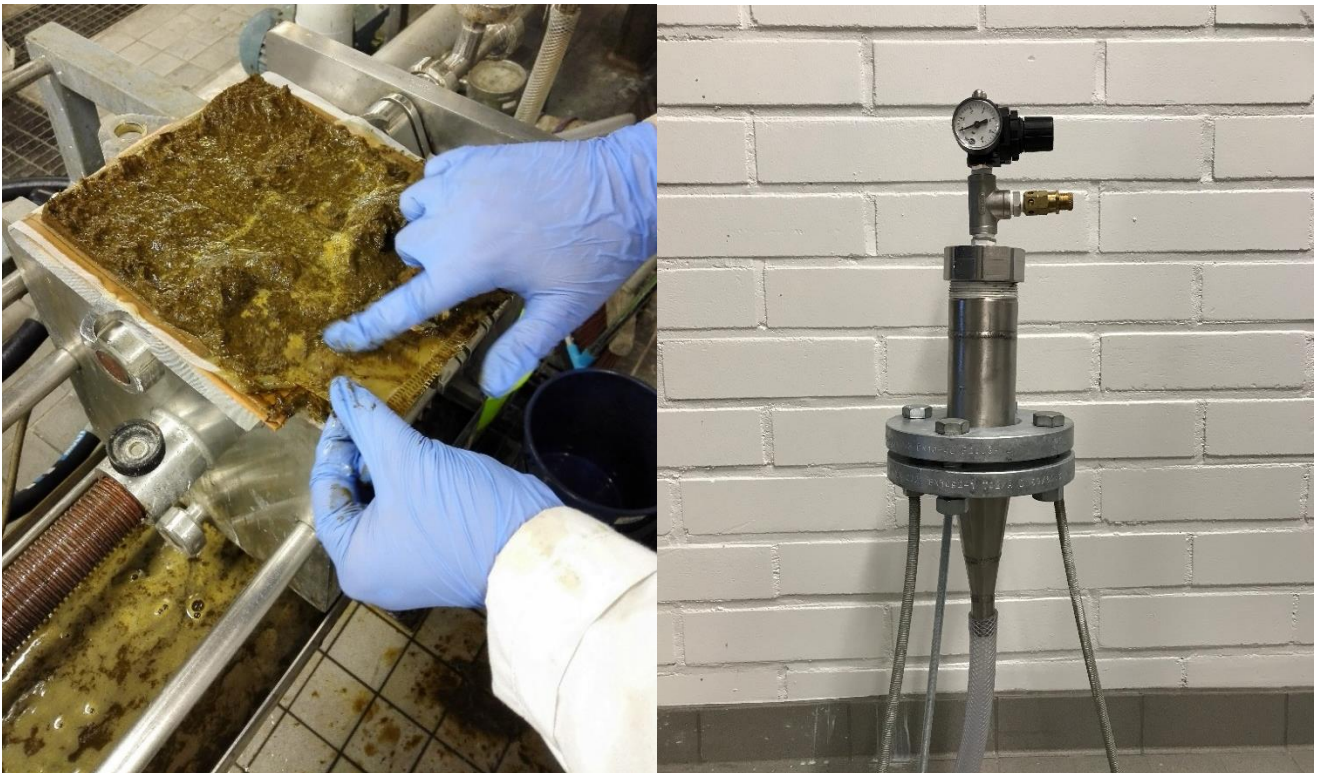
KUVA 1. a) Tukkiutuneen kehyssuotopuristimen kaku, b) Ylipainesuodatin, omavalmiste.
