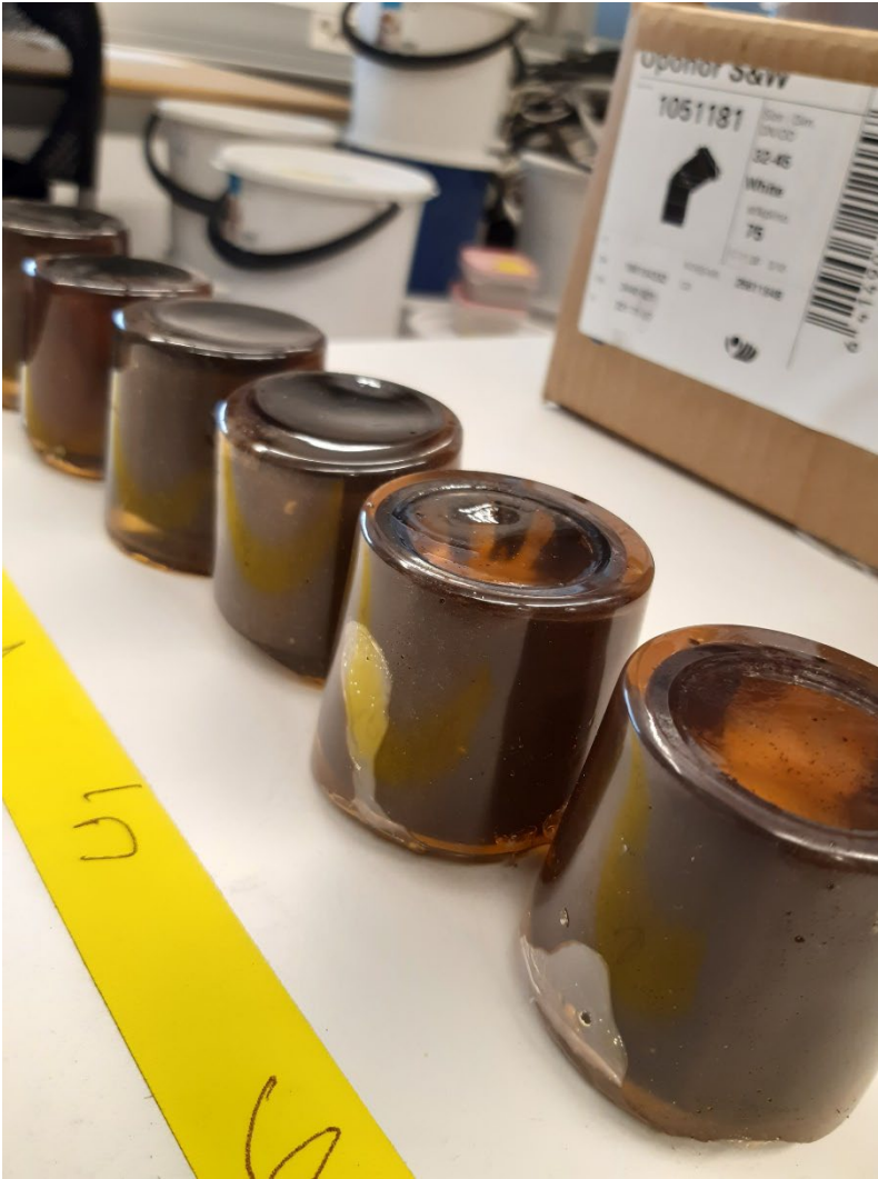
Kuva 8. Uhripalat valettuna epoksilla testien jälkeen
