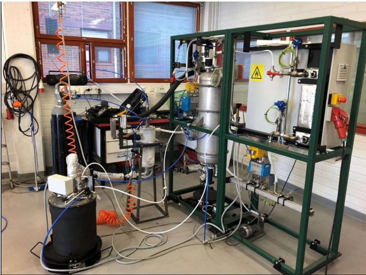
KUVA 1. Testikäyttöön rakennettu biokaasun jalostuslaitteisto. (Ojala 2022)
