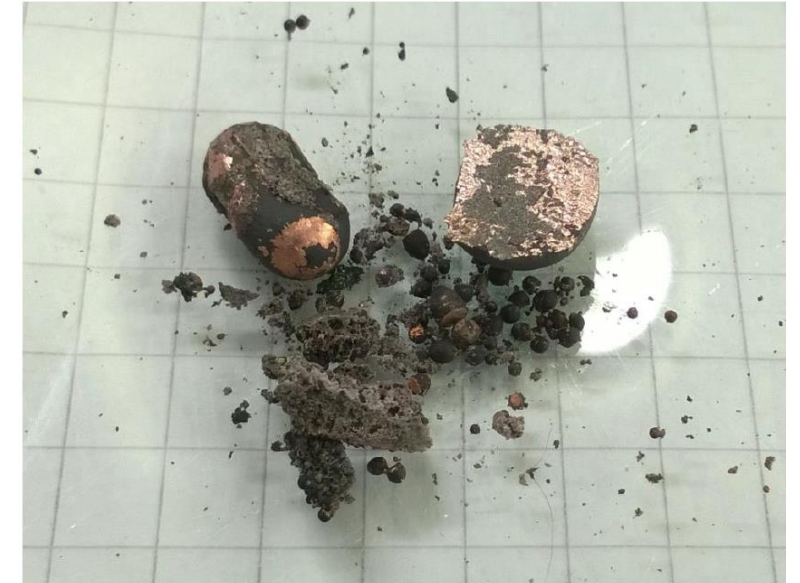
Kuva 8. Polttokokeessa talteen saatu kupari. (kuva: Centria-tutkimus ja kehitys)
