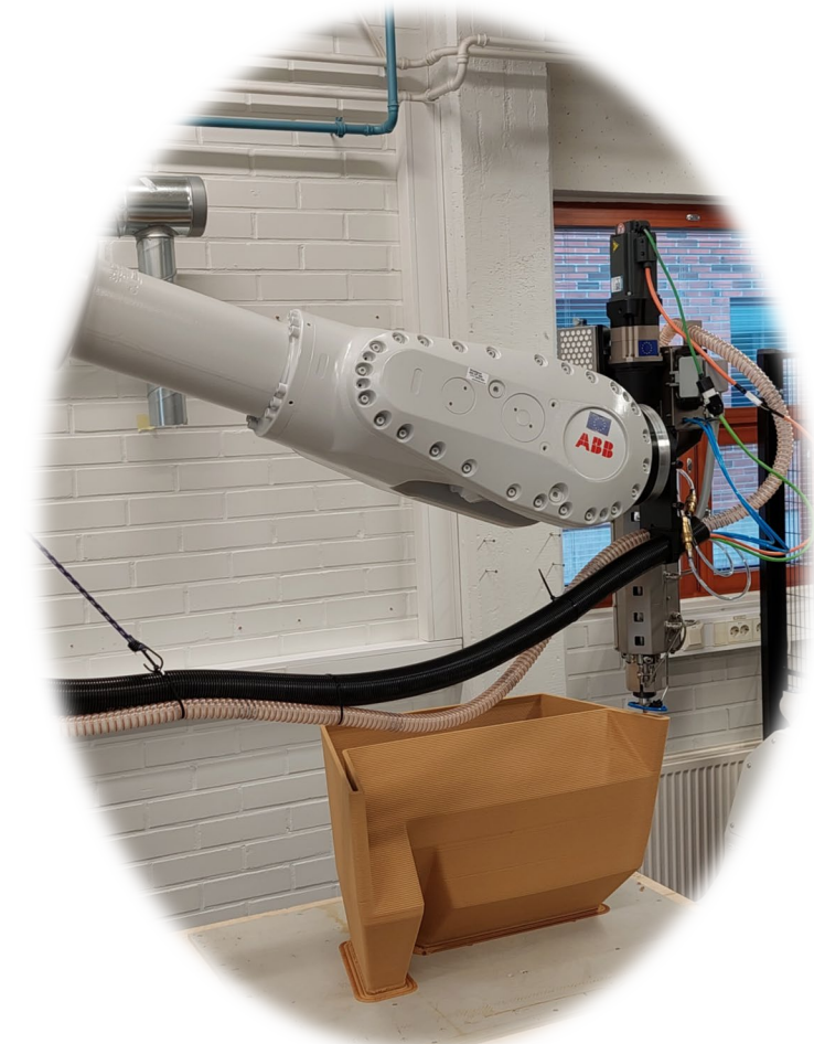
Centria-amk teollisen mittakaavan 3D-tulostusrobotti
